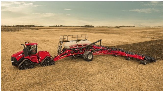
Case IH er klar med en trinløs transmission på deres QuadTrack-traktor. Pressefoto.
