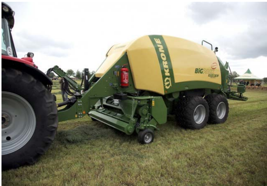
Den nye minibigpresser fra Krone gemmer blandt andet på fem bindeapparater frem for fire, som er mest almindelig i det segment. Fotos: Morten Damsgaard
