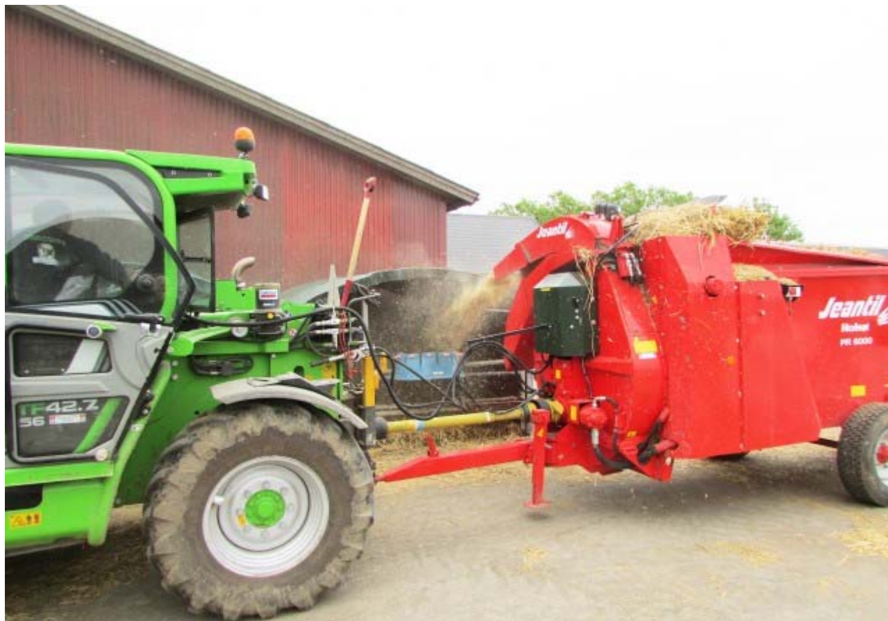
Jeantil halmstrøer PR6000 betjent af Merlo med PTO. Pressefoto.
