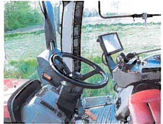
Angenehmes Lederlenkrad; statt Armaturen- brett gibt es alle wichtigen Anzeigen im rechten A-Holm.
