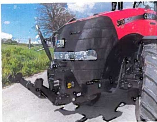
Das Fronthubwerk hebt fast 4 t, die gefederte Vorderachse hat außenliegende Zylinder.
