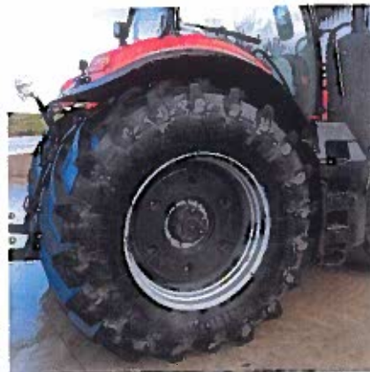
2,15 m hohe 900er Räder und bis zu 1 250 kg Radgewichte auf jeder Seite sorgen dafür, dass die Zugleistung auch auf den Boden kommt.
