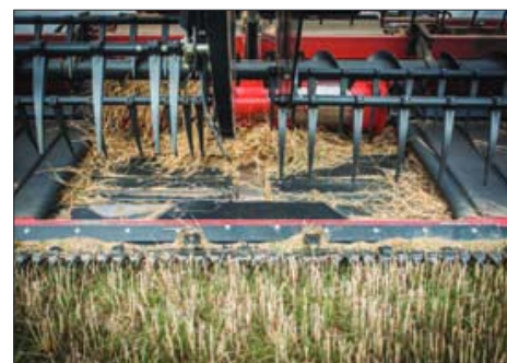
Case IH Sejlskærebordet har hydraulisk centertræk.
