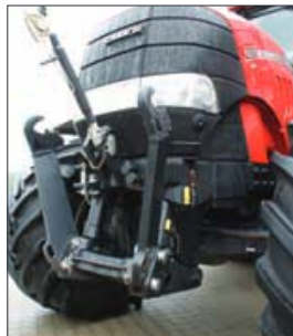
Frontliften løfter 3.785 kg og kan betjenes med trykknapper foran på traktoren.
