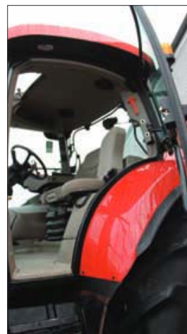
Kabinen på Puma 230 CVX er med kun fire stolper, og den brede dør giver en fin adgang til kabinen.
