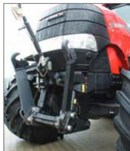
Frontliftens løfter 3.785 kg og kan betjenes med trykknapper foran på traktoren.
