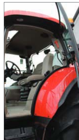
Kabinen på Puma 230 CVX er med kun fire stolper, og den brede dør giver en fin adgang til kabinen.
