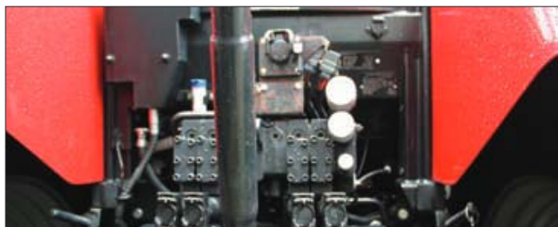
Bagpå er traktoren monteret med fire dobbeltvirkende hydraulikventiler samt udtag til LS.
