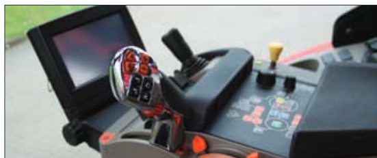
Hovedparten af traktorens funktioner indstilles fra armlænet og med kørehåndtaget.
