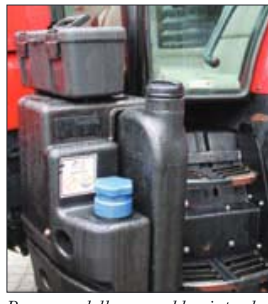
Puma-modeller, som blev introduceret i 2012, var de første traktor-modeller fra Case IH med AdBlue anlæg.
