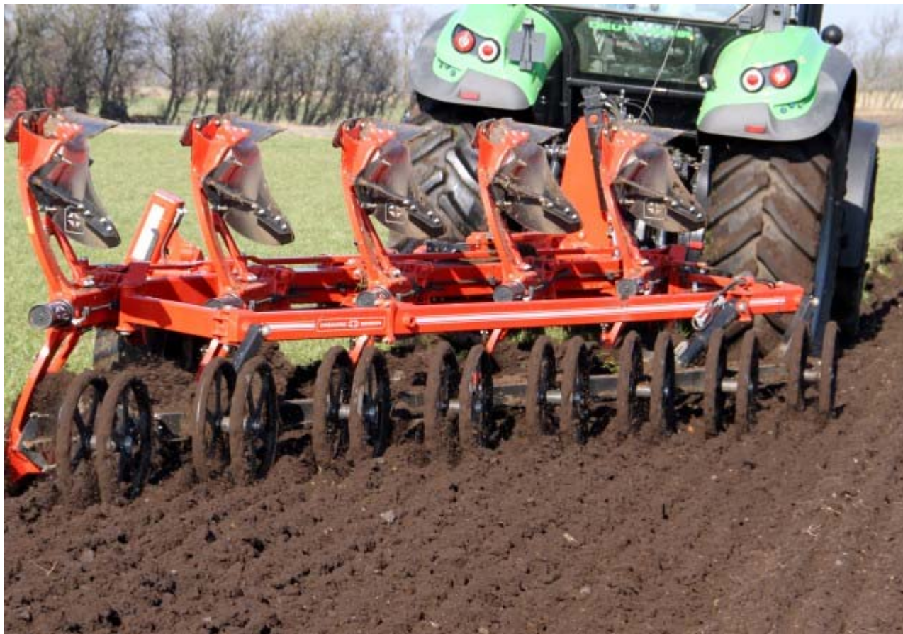
Grégoire Besson Andpak pakker jorden med valsede stålringe, der er monteret parvist på bladfedre og som automatisk indstiller sig til plovens arbejdsbredde. Foto: Helge Plougmann Nielsen.
