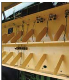
Presseren har plads til to gange 16 rulle garn.
