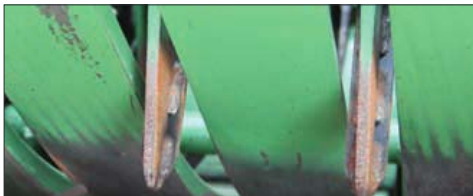
Den brugte Krone Big Pack 12130 er blevet opdateret med blandt andet bredere indføringssvinger i oppakkersystemet.
