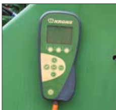
Monitoren har en magnet på bagsiden og er derfor let at montere i førerkabinen. Monitoren indeholder informationer om det totale antal pressede baller.
