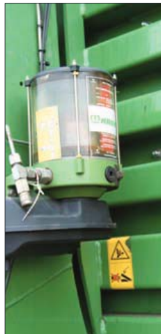
Presseren har centralsmøreanlæg og da den kun har tre små kæder er den daglige vedligehold hurtigt overstået.
